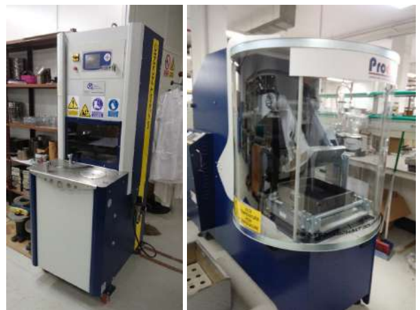
Compactador xiratorio. Superpave Gyrotronic compactor (Gyrotronic) e Compactador de placa. Heated Roller compactor
