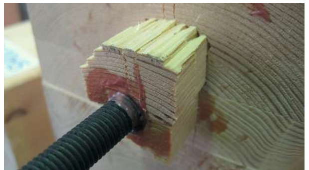
Sistemas de mellora da ancoraxe de barras de aceiro encoladas en madeira
