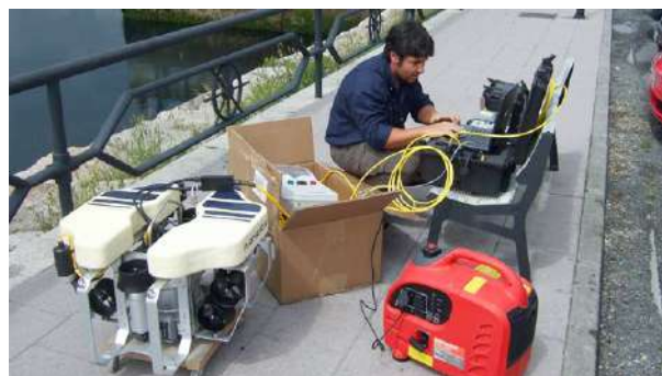
Vehículo de Operación Remota (ROV) para a inspección de infraestruturas e fondos mariños a gran profundidade
