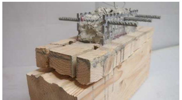
Conectores de sección composta Glulam-Formigón e Glulam+CLT
