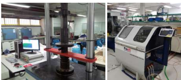
Prensa estática de Ibertest e máquina de pista (Hamburg Wheel tracker)
