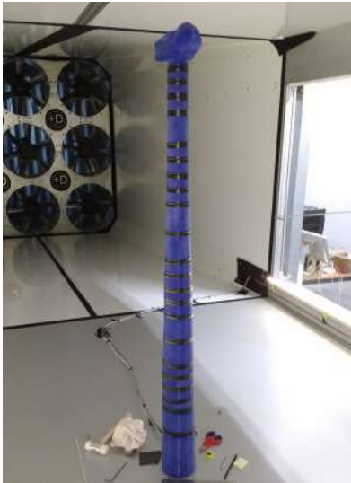
Ensaio de xuntas verticais de torres aeroxeneradoras de formigón pretensado
