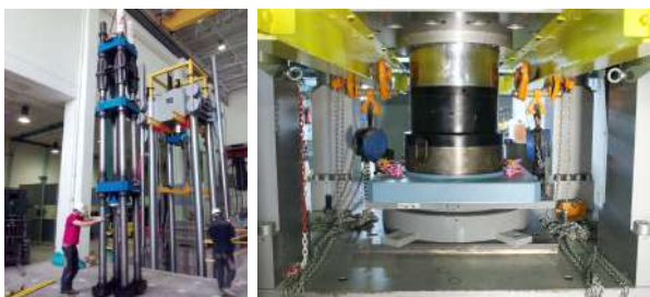
Ensaio a fatiga de sistemas de pretensado e ensaios de aparatos de apoio de neopreno confinado (Prensa de gran capacidade MTS-15MN)
