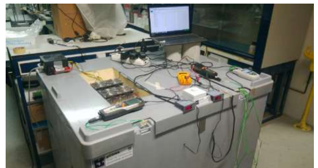
Caja-Caliente: medida de propiedades térmicas de materiais e elementos
