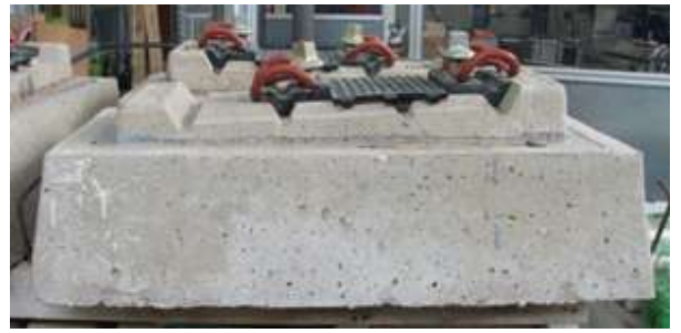
Bloque prefabricado para montaxe da subsección do carril no prototipo de vía en placa
