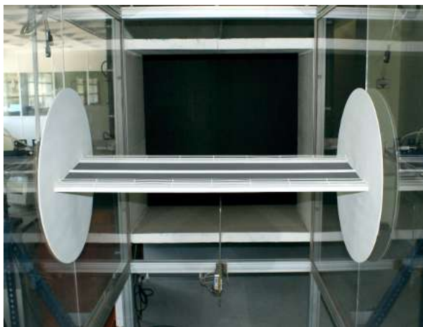
Ensaio aeroelástico sobre a sección dun taboleiro dunha ponte
