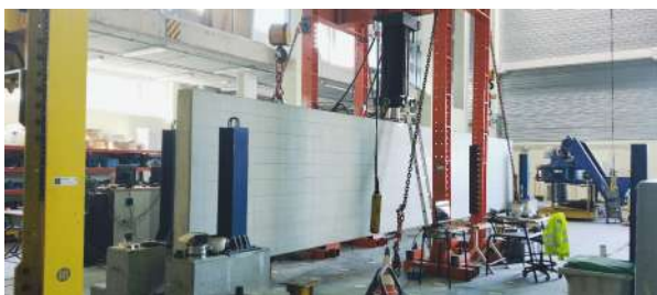
Ensaio a cortante dunha viga de formigón de 2 metros de canto (Récord Europeo)
