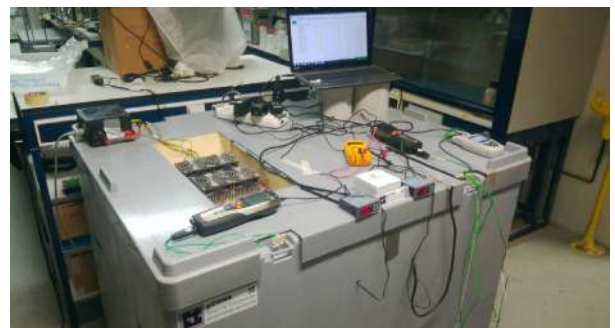
Caja-Caliente: medida de propiedades térmicas de materiales y elementos
