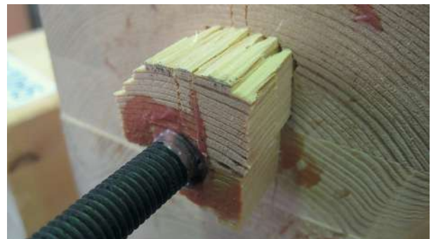
Sistemas de mejora del anclaje de barras de acero encoladas en madera
