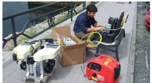
Vehículo de Operación Remota (ROV) para la inspección de infraestructuras y fondos marinos a gran profundidad
