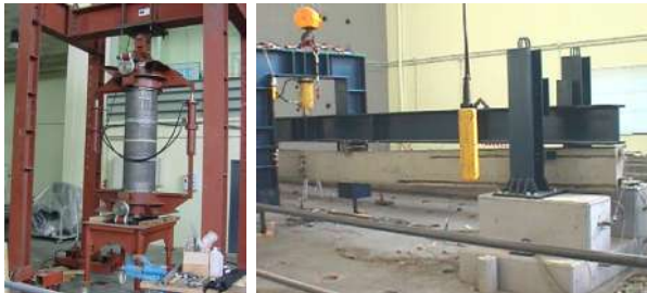
Ensayos de electrodos de grafito y de anclaje de armaduras pretensadas
