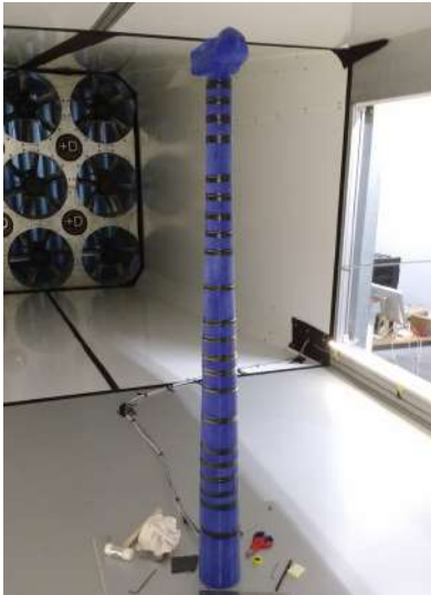
Ensayo en túnel de viento de capa límite de juntas verticales de torres de aerogeneración de hormigón pretensado
