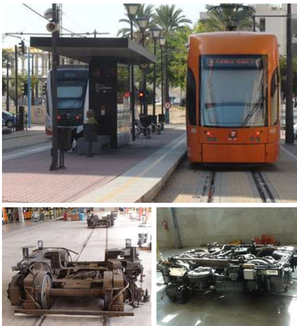
Metro ligero y tranvitrén en Alicante. Sistemas de Bogie
