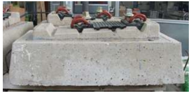
Bloque prefabricado para montaje de la sujeción del carril en el prototipo de vía en placa
