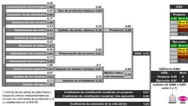
Aplicación informática de evaluación de la sostenibilidad de estructuras de hormigón, realizada para el Ministerio de Fomento (Gómez et al. 2011)
