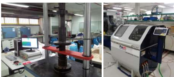
Prensa estática de Ibertest y máquina de pista (Hamburg Wheel tracker)
