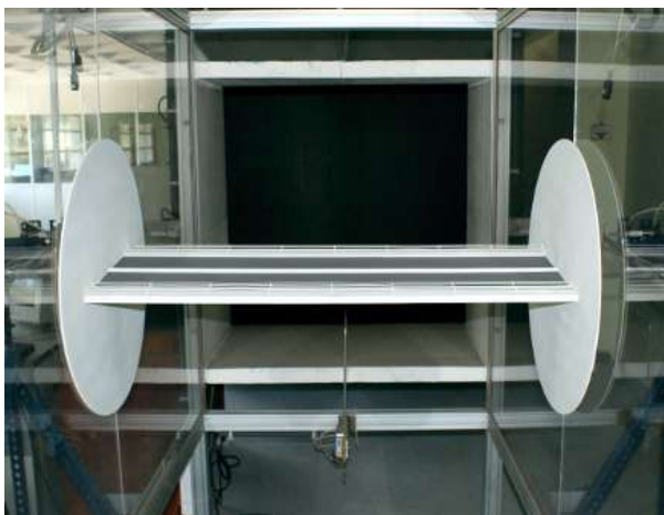
Ensayo aeroelástico sobre la sección de un tablero de un puente
