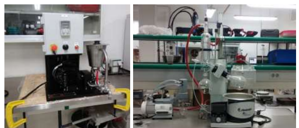
Molino coloidal para fabricación de emulsiones bituminosas y evaporador rotatorio
