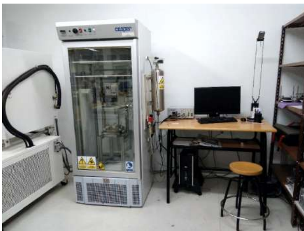
Prensa servo neumática universal NU14 (Cooper)
