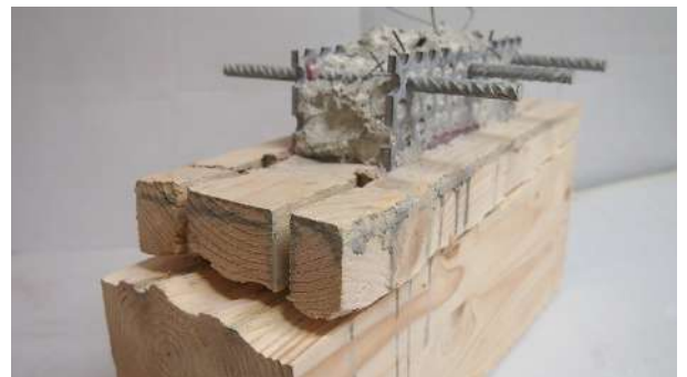
Conectores de sección compuesta Glulam-Hormigón y Glulam+CLT
