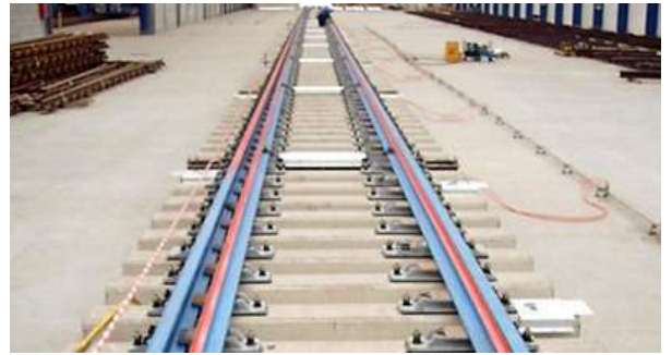
Cambio de un prototipo de desvío de alta velocidad de concepción íntegramente española
